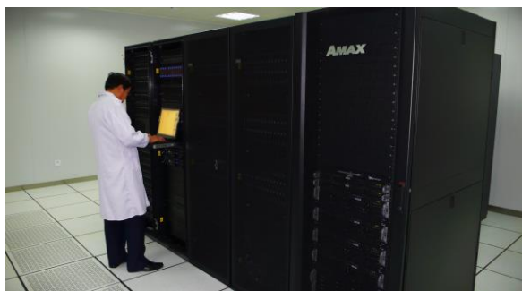
高性能 GPU/CPU 协同并行计算集群系统及其内部结构
